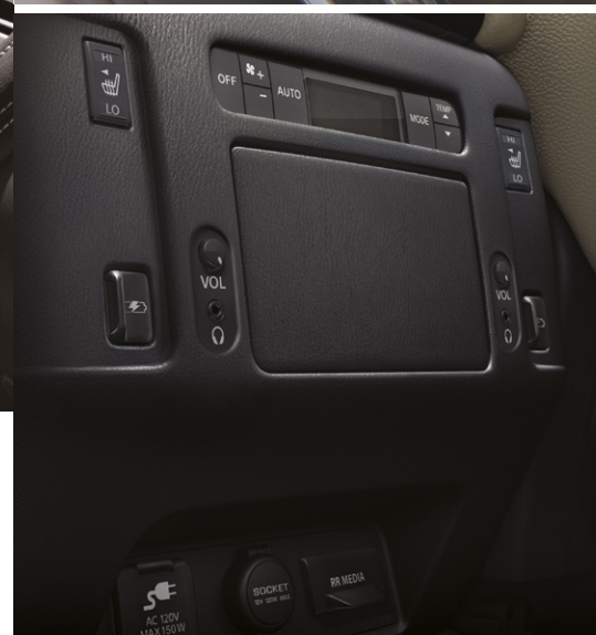
Consola central con 2 entradas Jack para audífonos, puerto HDMI, socket de 12 V y tomacorriente en la parte posterior
